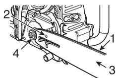
1. Scanalatura      2. Foro olio      3. Barra guida      4. Ingranaggio
