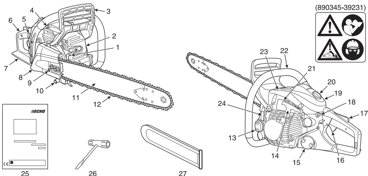
1. **Rampone** - Dispositivo, montato davanti al punto di montaggio della barra guida, che agisce da perno se a contatto con un albero o un tronco.
