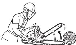
La funzione del freno catena consiste nell'arrestare la rotazione della catena dopo un contraccolpo.
