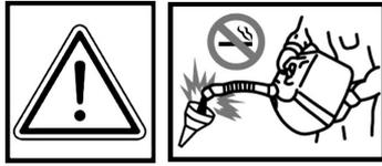
Per prevenire l'esplosione della batteria, tenete scintille, fiammiferi accesi e fiamme lontani dalla stessa. Il gas della batteria può esplodere.
