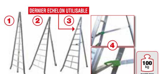
Ouvrir l'échelle et fixer le bras de sécurité comme indiqué dans le dessin n. 2. Bloquer le crochet du bras de sécurité comme indiqué dans les dessins n. 3 et 4. La correcte inclinaison est entre le 65° et le 75°. Les échelons doivent être parallèles au sol.
