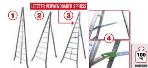
Öffnen Sie die Leiter und positionieren Sie das Stütze (Bild 2). Festigen Sie die Stütze-Stange (Bild 3-4). Versichern Sie sich, dass die Leiter richtig geöffnet ist und beachten Sie die korrekte Neigung (zwischen 65° und 75°). Die Fläche der Sprossen soll zum Boden parallel sein.
